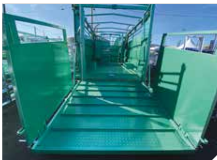
Pont hydraulique et volets
