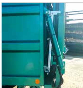
Béquille hydraulique de série.
