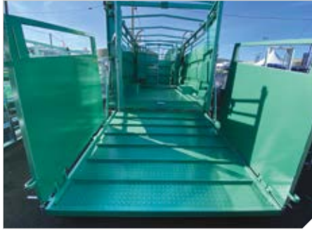
Pont hydraulique et volets
