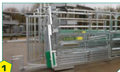
1 • Porte de contention manuelle progressive (avec poignée déportée d'origine) ou autobloquante .
