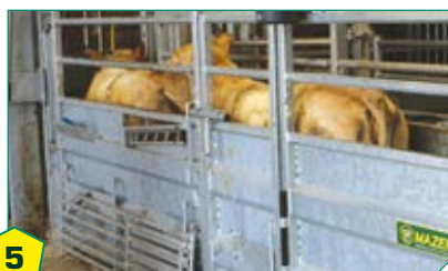
5 • Portillon central pour accéder à l'arrière du bovin immobilisé. Accès à l'animal par les 2 côtés (tubes latéraux escamotables).
