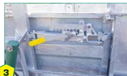
3 • Réglage de largeur par crémaillère pour éviter les demi-tours des jeunes bovins (sur certains modèles).
