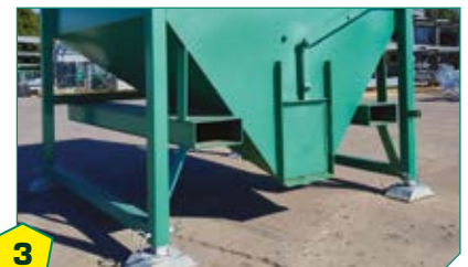
3 • Mobilité : les fourreaux permettent de déplacer facilement les transbordeurs.
