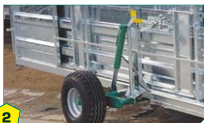
2 • Essieu sur vérin avec pose à terre complète et rapide : tube pour essieux amovible pour position route.
