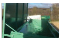
2 vérins à gaz facilitent l'ouverture du toit.
